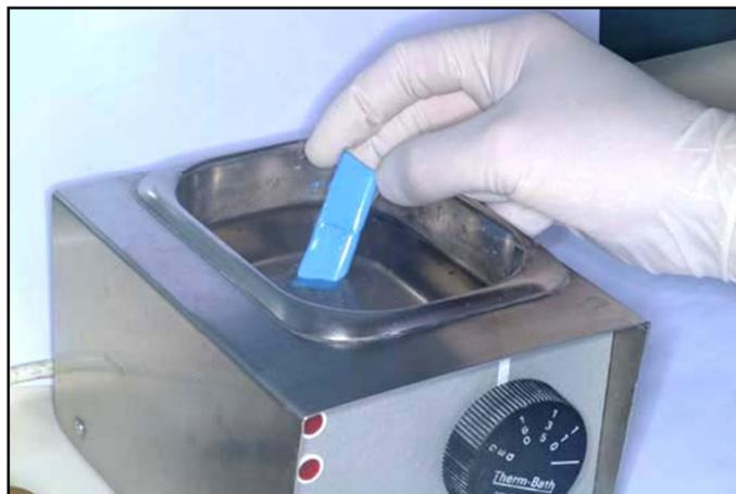
Fig. 16. Calentar solo los extremos del tope posterior.
